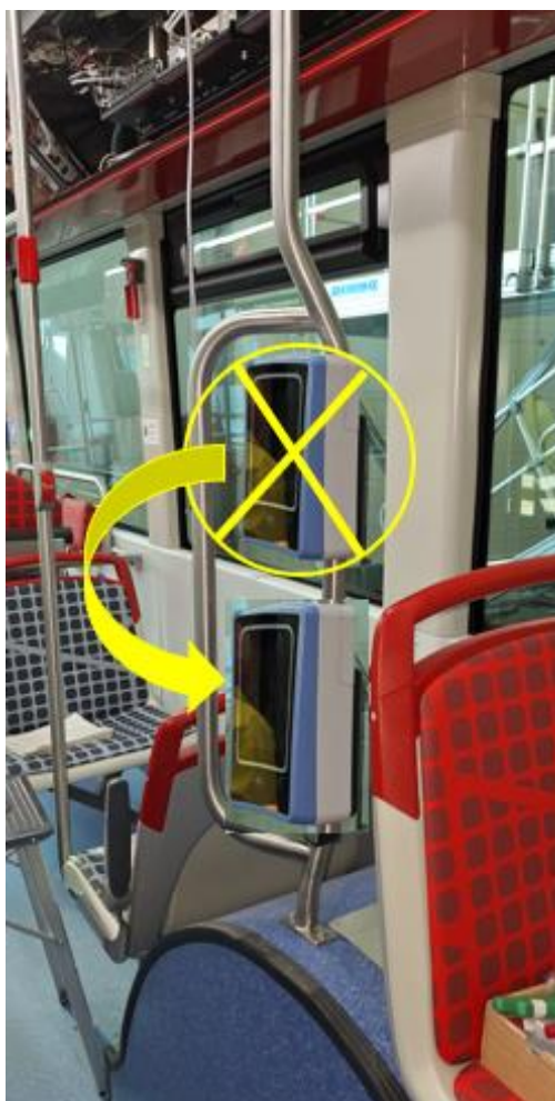
Imagen 10. Soporte T-Mobilitat detrás del conductor en vehículo estándar.
