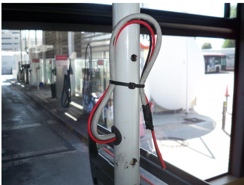
Imagen 14. Agujero de salida cables validadora.
