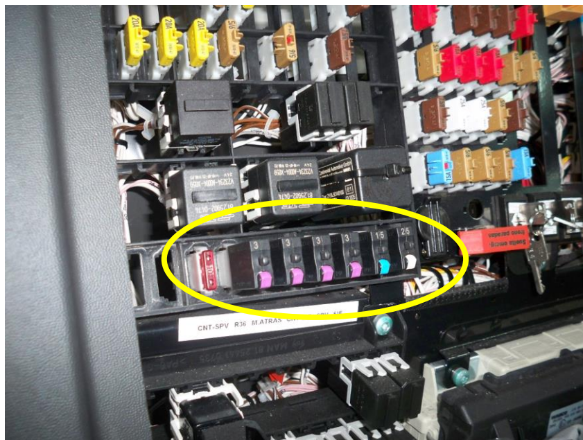
Imagen 2. Ejemplo de cuadro eléctrico con fusibles para la Red Embarcada
