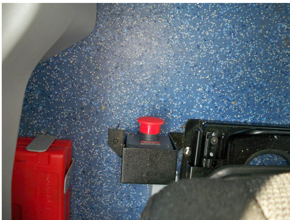
Imagen 28. Colocación pulsador de emergencia
