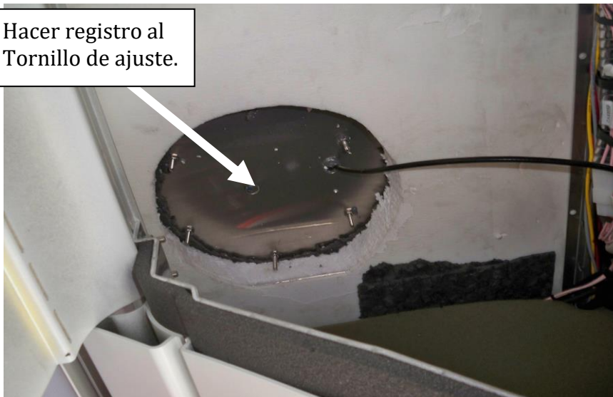
Imagen 17. Detalle posterior Antena de Radio Tetra
